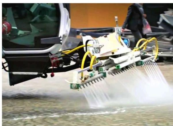
Barre de pulvérisation pour nettoyage des rues à l'eau froide | Contrôle via joystick (orientation/télescopique à 3 positions) Réservoir d'eau en plastique rotomoulé | Capacité 528 gal. (2000 L)
