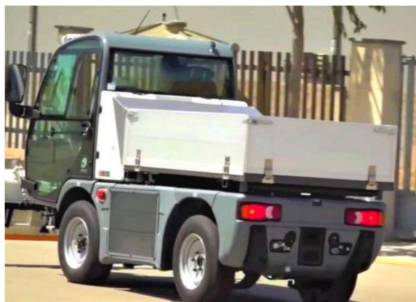
Plateforme de chargement en aluminium avec côtés rabattables et déversement hydraulique trilatéral (arrière/latéral) 72,5" x 51,2" x 16,5" (1840 x 1300 x 420 mm)
